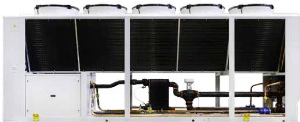
La gamme sont des réfrigérateurs de liquide monobloc à condensation par air adaptés pour installation à l'extérieur. Les unités sont prévues à un ou deux circuits frigorifiques indépendants équipés avec compresseurs hermétiques de type scroll en R410A.
